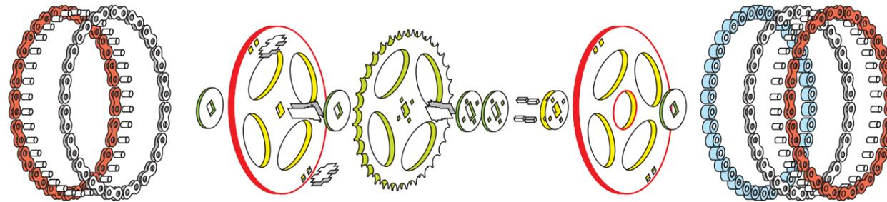
図の赤いリングの部分にミシン油などの潤滑油を塗ると滑らかな回転を得る事が出来ます。
